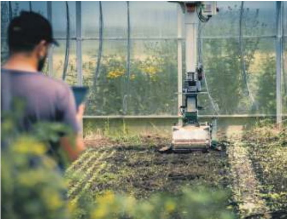
Un portique robotique se déplace sur rails au-dessus des cultures des Fermes Debout, pour réaliser une partie des tâches pénibles (préparation du sol, semis, plantage de mottes, désherbage).
