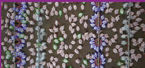
Système de suivi individuel de poulets par images. Image-based individual chicken monitoring system.
